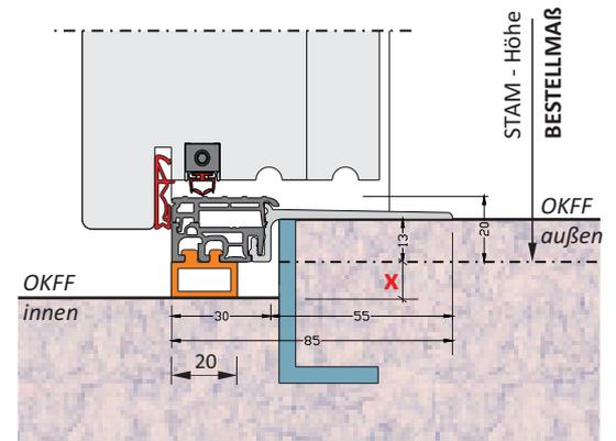
Ausführung mit Bodeneinstandsprofil C1 aus Kunststoff ist auch möglich!
