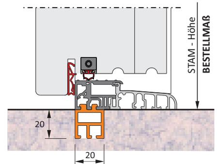
Ausführung mit Bodeneinstandsprofil C1 aus Kunststoff ist auch möglich!
