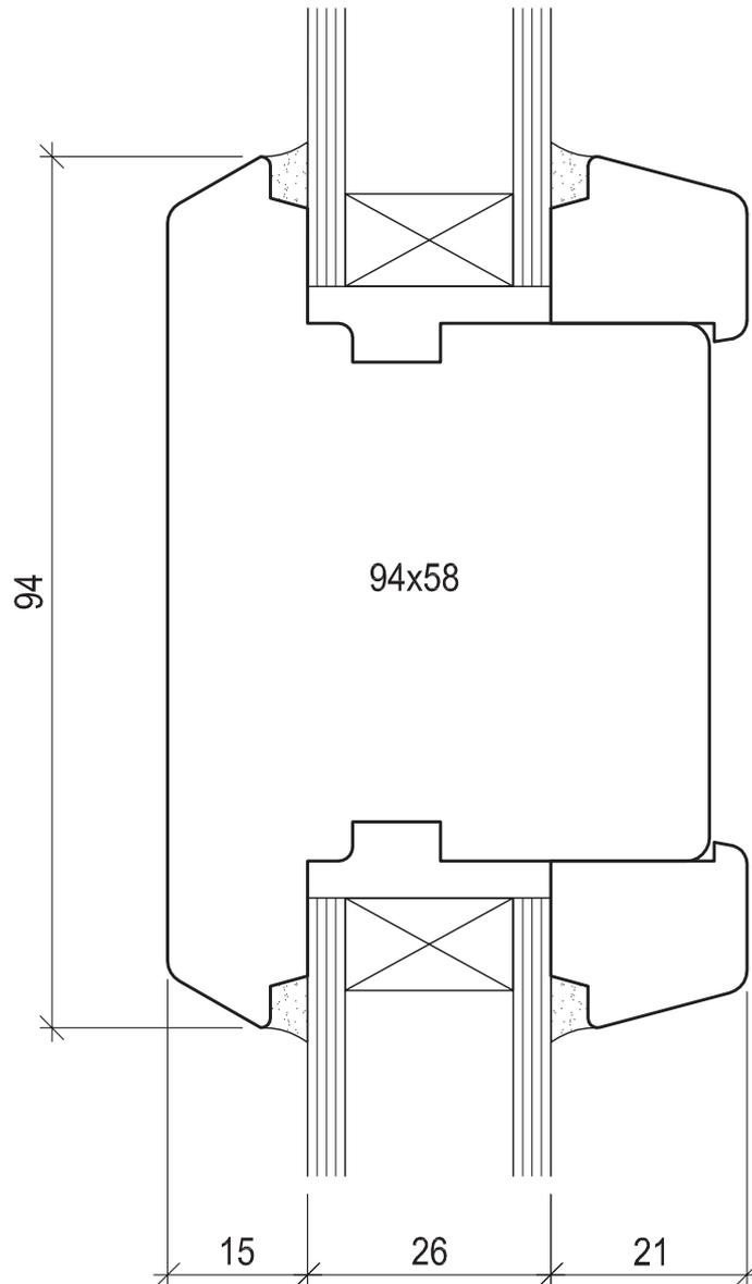
Kämpfer rahmenverglast / rahmenverglast
